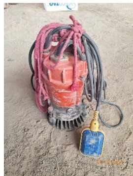
รูปที่ 2-25 เครื่องสูบน้ำสำรองที่จัดเตรียมไว้ในบริเวณพื้นที่ก่อสร้าง
