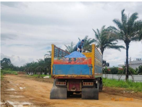
รูปที่ 2-8 คนงานดำเนินการปิดคลุมและผูกมัดวัสดุก่อสร้าง เพื่อป้องกันการตกหล่นขณะขนส่ง
