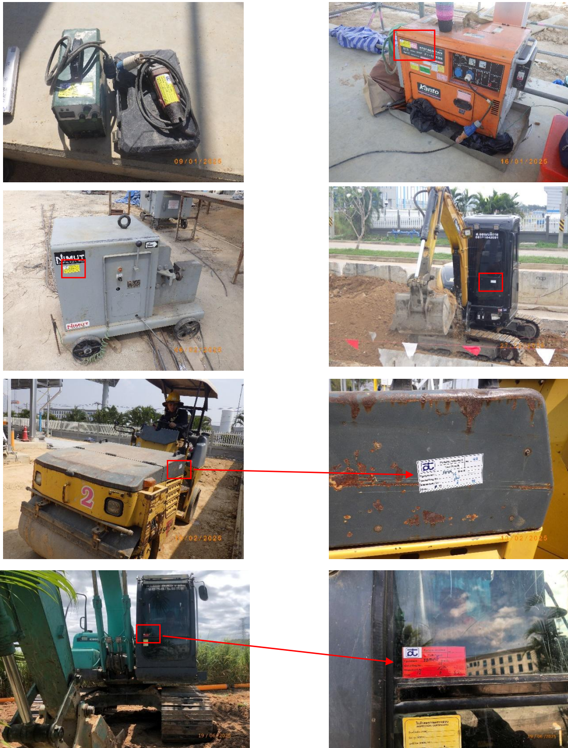
รูปที่ 2-11 สติกเกอร์แสดงการตรวจสอบสภาพเครื่องมือ เครื่องจักร และเครื่องยนต์
