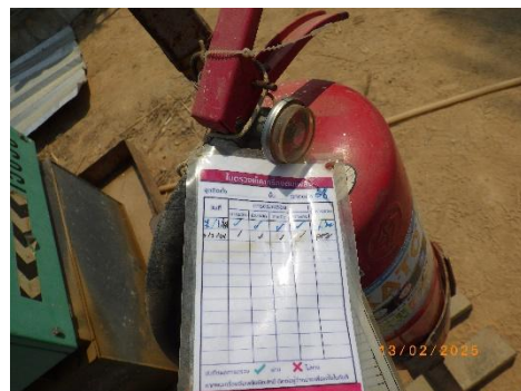
รูปที่ 2-41 ถังดับเพลิงบริเวณพื้นที่ปฏิบัติงาน และแบบบันทึกการตรวจสอบสภาพถังดับเพลิง
